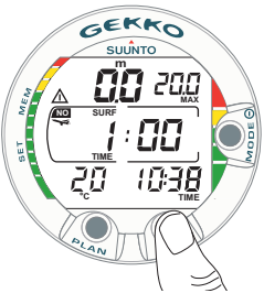
Fig. 3.27. Pantalla superficie, hora. Pulsando una vez el botón TIME, se visualiza el Modo Superficie.
