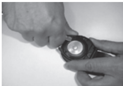
Fig. 5.2. Apertura del anillo de bloqueo.
