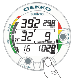
Fig. 3.24. Visualización alternativa. Pulse el botón TIME para visualizar en pantalla la hora actual, la profundidad máxima, el CBT (tiempo de inmersión transcurrido), y el O_2 %.
