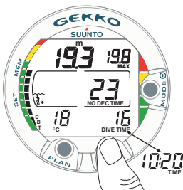
Fig. 3.7. Visualización durante la inmersión. La profundidad actual es de 19,3 m; el tiempo de inmersión sin descompresión es de 23 minutos en modo A0 / P1. La profundidad máxima alcanzada durante la inmersión es de 19,8 m; la temperatura del agua es de 18° C, y el tiempo de inmersión es de 16 minutos. Pulsando el botón TIME, se visualiza la hora durante 5 segundos.
