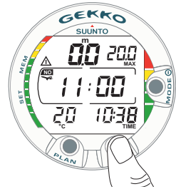
Fig. 3.28. Pantalla superficie, tiempo de espera antes de un desplazamiento aéreo. Pulsando dos veces el botón TIME, se visualiza el tiempo de espera antes de realizar un desplazamiento aéreo, indicado por el símbolo en forma de avión.
