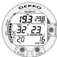
Fig. 3.22. Buceo en Modo Nitrox. Ajuste del porcentaje de oxígeno O_2 en 32 %.
