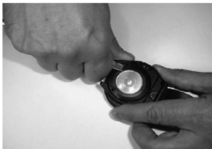
Fig. 5.2. Apertura del anillo de bloqueo.
