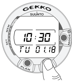
Fig. 2.1. Pantalla reloj. Pulse los botones PLAN o TIME para visualizar esta pantalla.
