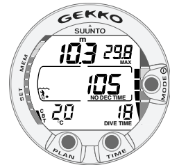
Fig. 3.11. Indicador de la velocidad de ascenso. Velocidad máxima autorizada. Cuatro segmentos
