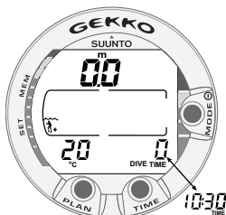
Fig. 3.3. Pantalla puesta en marcha III. Pantalla superficie : la profundidad y el tiempo de inmersión están a cero y la temperatura es de 20° C. Pulsando el botón TIME, se visualizan las pantallas alternativas de la hora y la temperatura.
