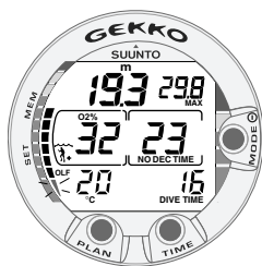
Fig. 3.25. La OTU alcanza el límite de toxicidad. El segmento inferior comienza a parpadear y suena la alarma acústica.
