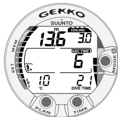
Fig. 3.16. Inmersión con paradas de descompresión, por encima de la profundidad base. La flecha ha desaparecido y la indicación ASC TIME ya no parpadea. Ud. se encuentra en la zona de descompresión.
