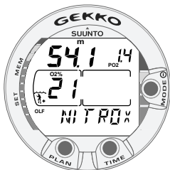
Fig. 3.20. Pantalla Nitrox. La profundidad máxima basada en los ajustes de O_2 % (21 %) y de PO_2 (1.4 bar) es de 54,1 m (177 pies).
