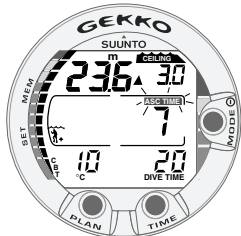
Fig. 3.15. Inmersión con paradas de descompresión, por debajo de la profundidad base. La flecha dirigida hacia arriba, el indicador intermitente ASC TIME, y la alarma acústica le recomiendan ascender. El tiempo total de ascenso mínimo, incluida la parada de seguridad, es de 7 min. La profundidad tope es de 3 m. (10 pies).
