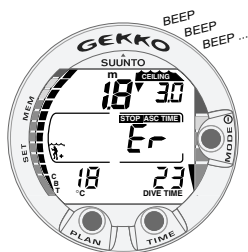
Fig. 3.18. Inmersión con paradas de descompresión, por encima de la profundidad tope. Se visualizan la flecha hacia abajo y la indicación de error Er. También se dispara la alarma acústica. Es necesario que vuelva a descender de inmediato (en un tiempo máximo de 3 min.) a la profundidad tope o por debajo de ésta.
