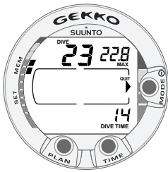
Fig. 4.13. Parámetros de la memoria histórica. Número total de inmersiones, número de horas, y profundidad máxima.
