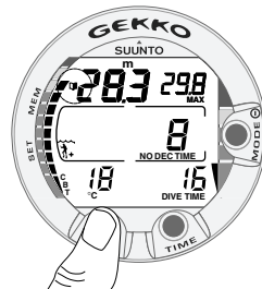
Fig. 3.8. Marcador activado. El marcador se señala en un punto del perfil de inmersión pulsando el botón PLAN. Se visualiza el símbolo del diario de buceo al pulsar el botón.
