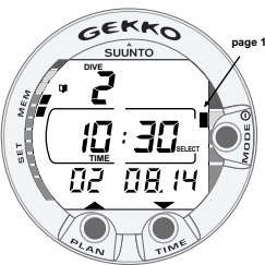
Fig. 4.6. Diario de Buqueo (Logbook), página I. Secuencia de visualización de las diferentes páginas de una inmersión.
