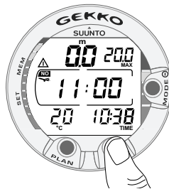
Fig. 3.28. Pantalla superficie, tiempo de espera antes de un desplazamiento aéreo. Pulsando dos veces el botón TIME, se visualiza el tiempo de espera antes de realizar un desplazamiento aéreo, indicado por el símbolo en forma de avión.
