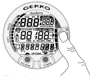
Fig. 3.1. Pantalla puesta en marcha I. Se visualizan todos los segmentos de la pantalla.
