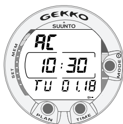
Fig. 2.4. La abreviatura AC indica que los contactos húmedos han sido activados.
